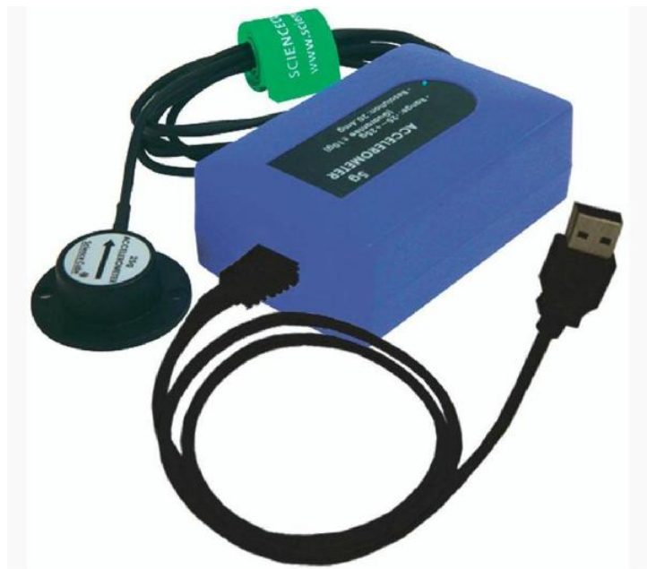
Σχήμα 3.3: Αισθητήρας επιτάχυνσης με ενσωματωμένη USB επικοινωνία
