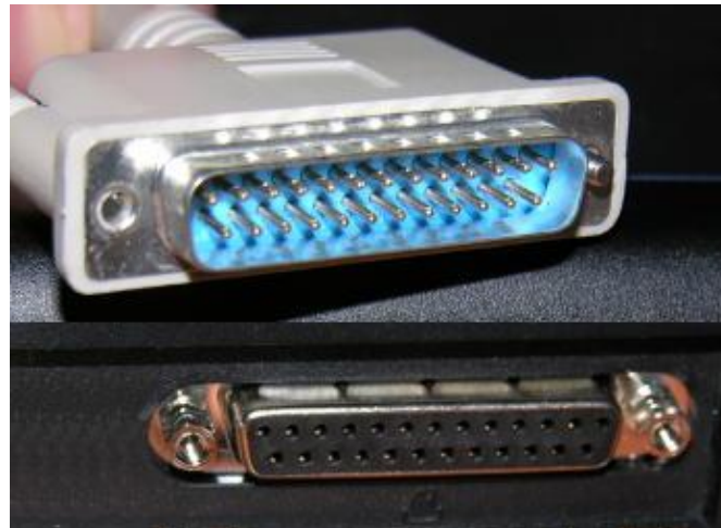
Σχήμα 5.2: “Αρσενική” και “θηλυκή” παράλληλη θύρα
