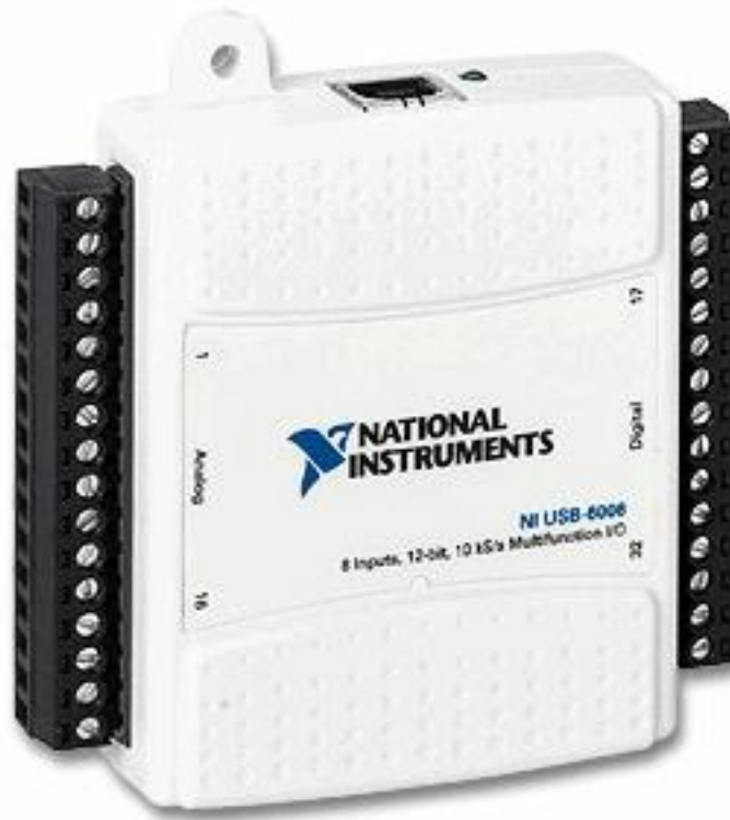
Σχήμα 6.2 Κάρτα συλλογής δεδομένων NI USB-6009
